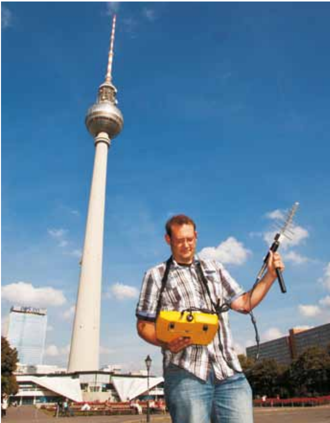
Abbildung 1: Anwendung des codeselektiven LTE-Messverfahrens mit Schwenkmethode
